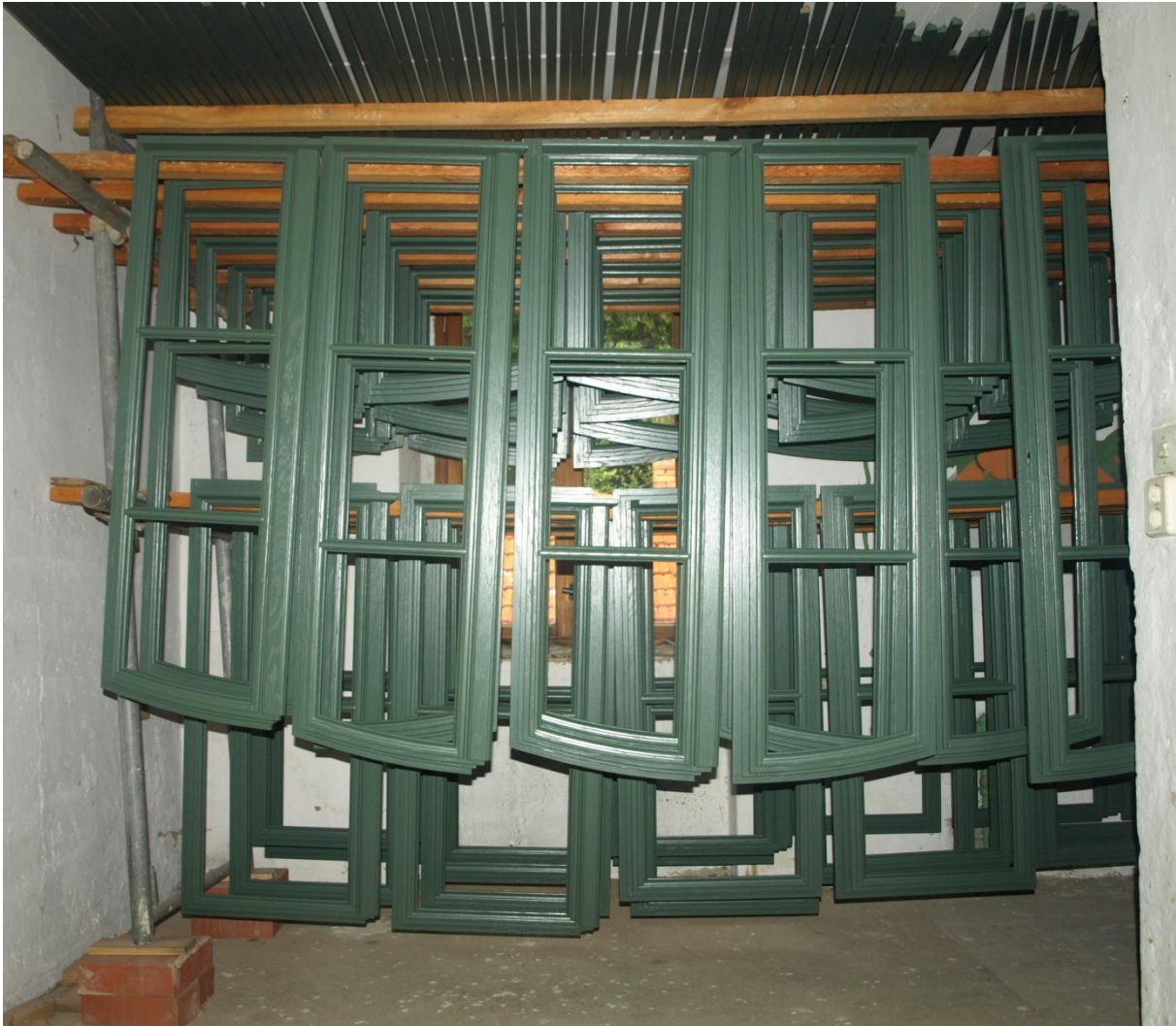
Abbildung 3: Ein Teil des Gerüsts mit fertig gestrichenen Fensterflügeln, die zum Trocknen vor der Weiterverarbeitung zwei Monate Zeit erhalten.
